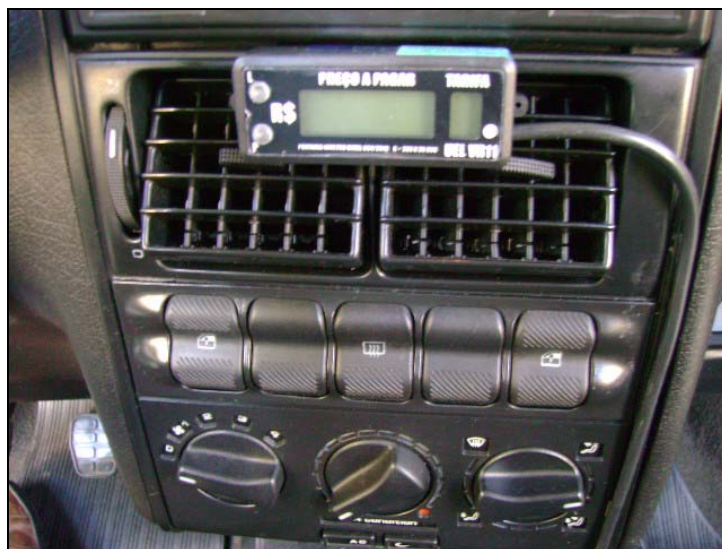
INSTALAÇÃO NO GOL ABAIXO DO RADIO. O CABO FOI FIXADO NO PAINEL COM FITA DUPLA FACE.
