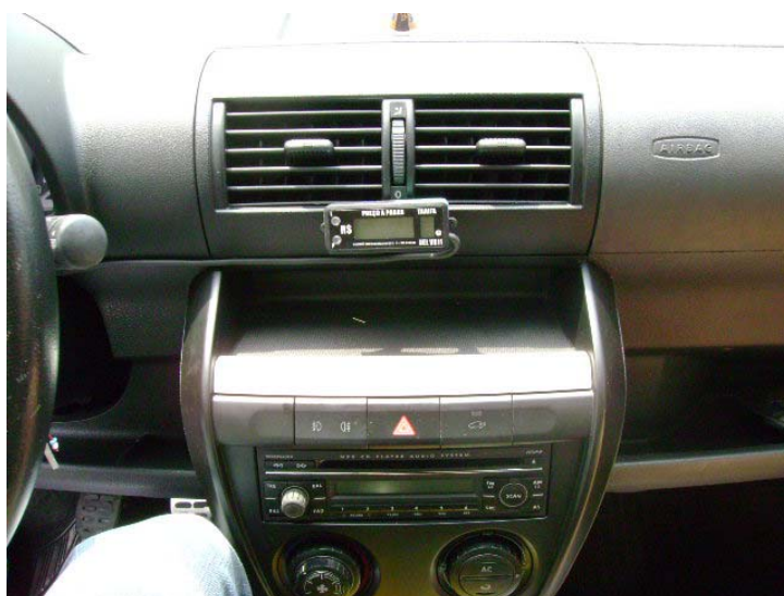
VR11 INSTALADO NO CROSS FOX. O CABO FOI FIXADO NO PAINEL COM FITA DUPLA FACE
