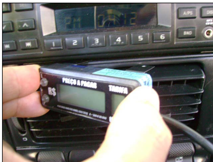
INSTALAÇÃO NO GOL ABAIXO DO RADIO. NOTE O SUPORTE DO TAXÍMETER SENDO COLOCADO NA FRESTA DO RADIO.
